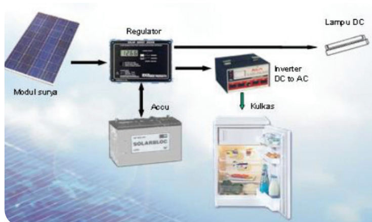
Gambar 2.5 Komponen konversi energi surya menjadi energi listrik
