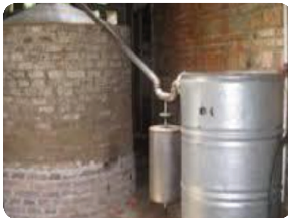
Sumber: Dokumen Kemendikbud Gambar 2.8 Alat pirolisis
