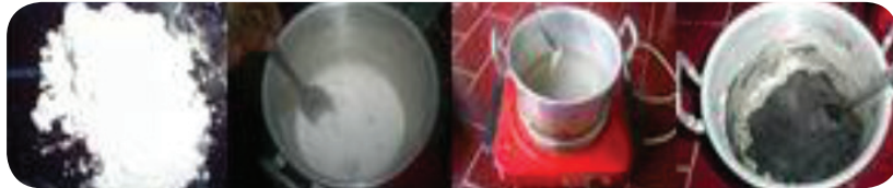
Gambar 2.13 Pencampuran arang dengan kanji dengan kanji
