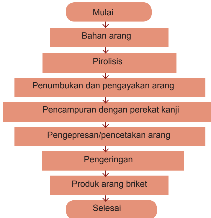
Gambar 2.11 Diagram pembuatan arang briket
