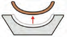
Gambar penampang cetakan cekung dan hasil cetaknya
