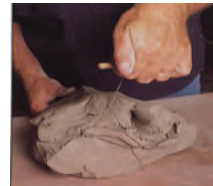
Irislah tanah liat. Bila proses ini berjalan bagus maka bagian irisan tampak merata dan bebas udara
