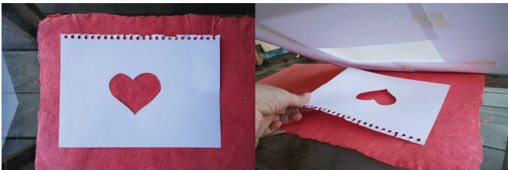
Gambar 2.20 Letakkan stensil di antara kertas dengan screen .
