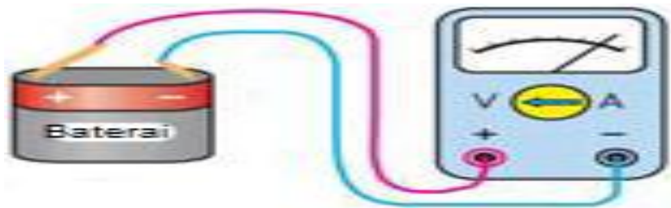
Gambar 52. Rangkaian menggunakan Voltmeter
