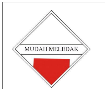
Gambar 8. Tanda/Label pada Limbah B3 yang Mudah Meledak
