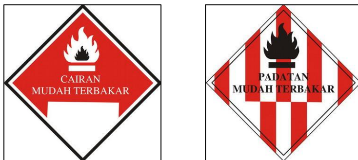
Gambar 9. Tanda/Label pada Limbah B3 yang Mudah Terbakar
