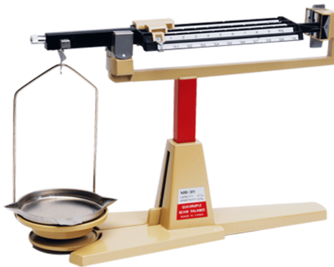
Gambar 2. Neraca Satu Piring - Tiga Lengan Sumber: http://www.easthighscale.com
