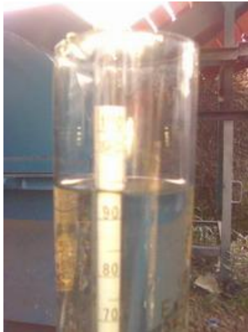
Gambar 19. Pengukuran kadar etanol (alkohol) dengan alkoholmeter
