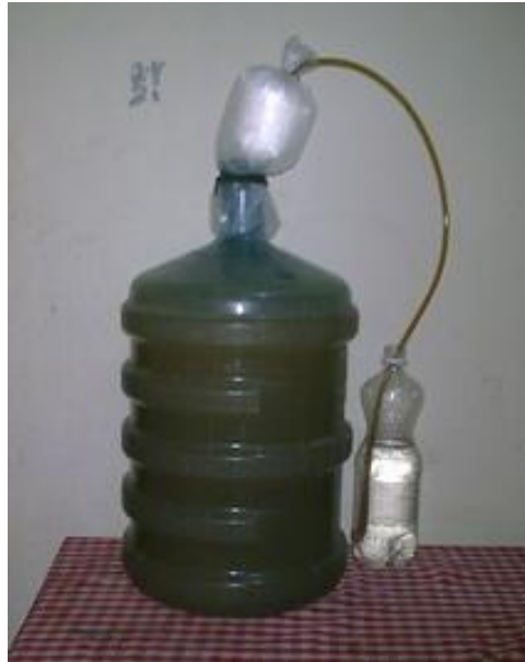
Gambar 14. Fermentasi bahan baku bioethanol
