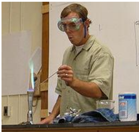
Gambar 5. Contoh analisis kualitatif dengan uji nyala
