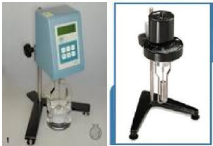
Gambar 22. Viskosimeter Brookfield
