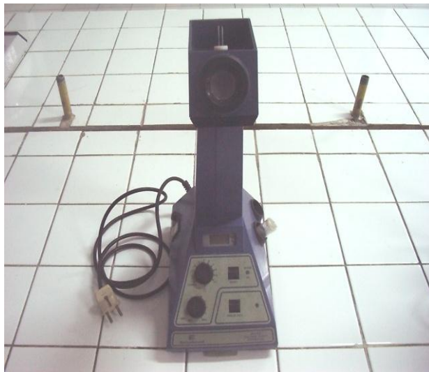
Gambar 29. Alat "Melting Point Aparatus"
