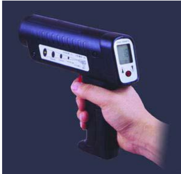
Gambar 28. Termometer Inframerah atau Non-kontak
