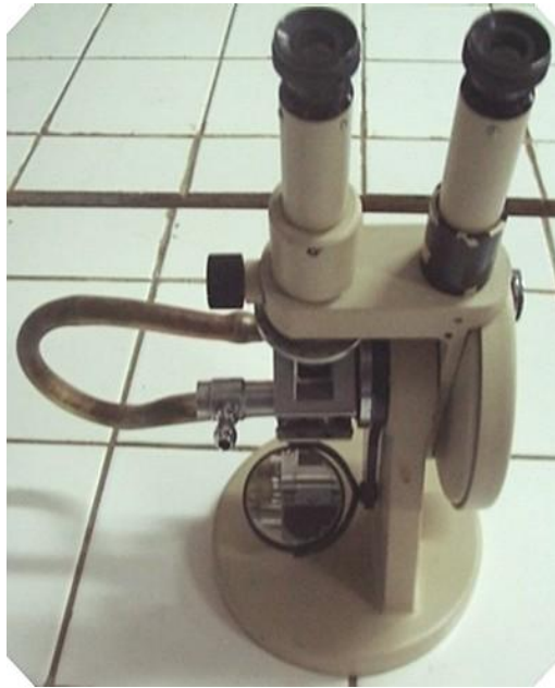
Gambar 21. Alat Penetapan Index Bias (Refraktometer)
