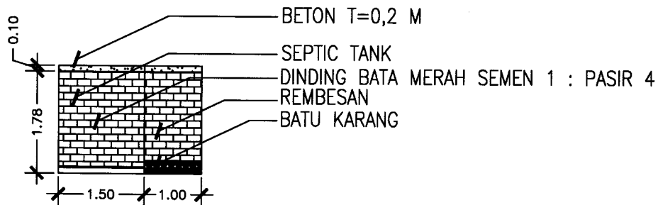
Detail septic tank dan rembesan dengan komposisi dinding bata semen 1 : pasir 4 agar air bersih tidak tercemar oleh sisa pembuangan
