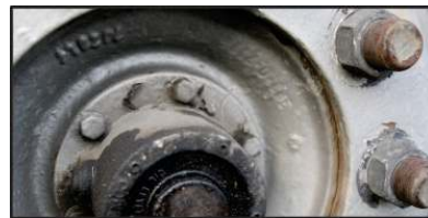
Gambar 1.2. Baut roda belakang truk.
