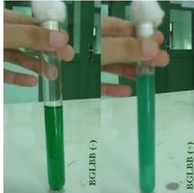
Gambar 19. Hasil uji negative (kiri) dan hasil uji positif yang ditandai adanya gelembung gas pada tabung durham (kanan)
