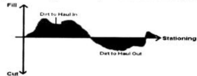
Gambar potongan untuk pekerjaan galian dan timbunan
