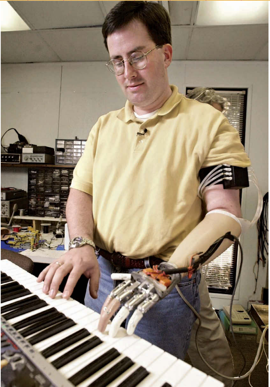
▲ Jay Schiller menggunakan tangan bionik yang dikembangkan Universitas Rutgers untuk bermain keyboard elektronik. Elektroda menangkap sinyal dari saraf Schiller dan menggerakkan mesin pada anggota tubuh.
