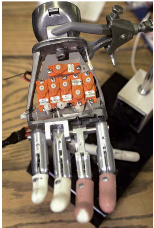
▲ Tangan bionik dapat menggerakkan tiap jarinya secara terpisah, sehingga si penerima tangan bionik dapat memegang bola, memainkan piano, dan menggunakan pensil.
