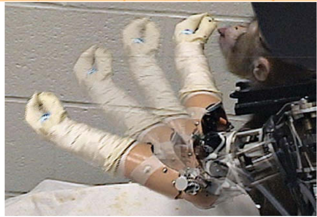
▲ Seekor monyet yang dipasang tangan robotik dapat menggerakkan tangannya lewat penghubung komputer-otak yang menerjemahkan sinyal otak ke dalam gerakan.
