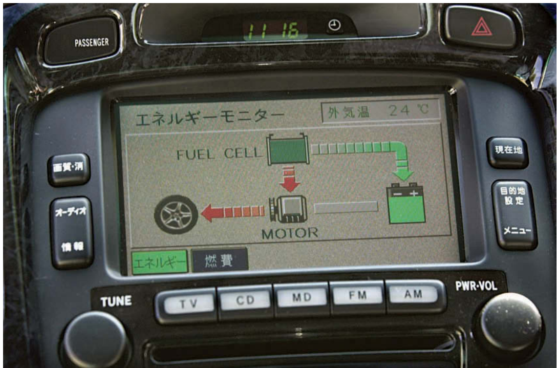
▲ Tampilan dasbor kendaraan sel bahan bakar Toyota yang saat ini masih dalam pengembangan menunjukkan kepada pengemudi dari mana datangnya energi yang menggerakkan mobil.
