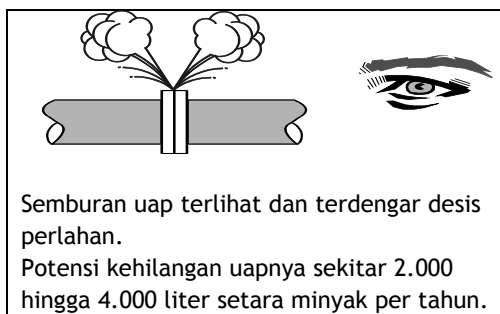
Gambar 6-10. Metode praktis dalam memperkirakan laju kehilangan uap.
