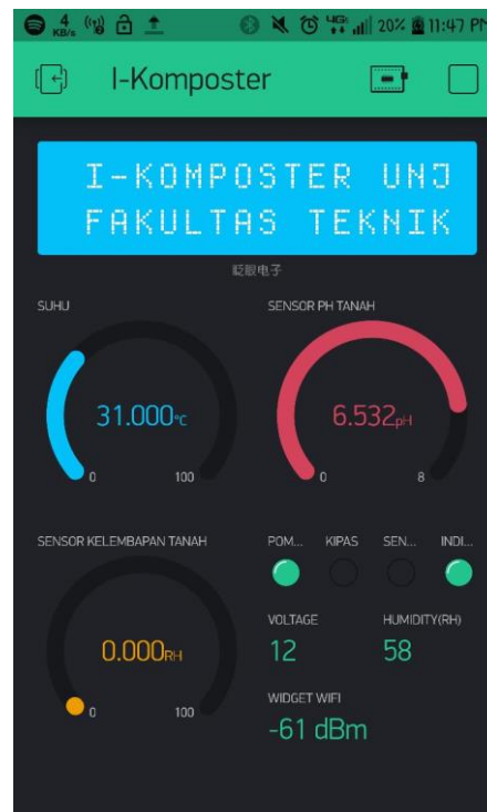
Gambar 5 Tampilan monitoring sistem I-Komposter pada smartphone.
