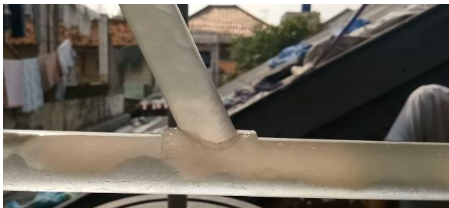
Gambar 2 Hasil Proses Pemisahan kerosene dan air pada kecepatan superficial kerosene 0,53 m/s dan kecepatan superficial air 0,8 m/s.
