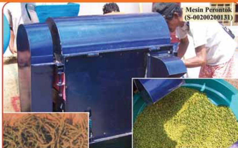
Perontokan (Kapasitas 650 kg/jam)
