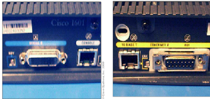
Gambar 41 Port – port pada Router
