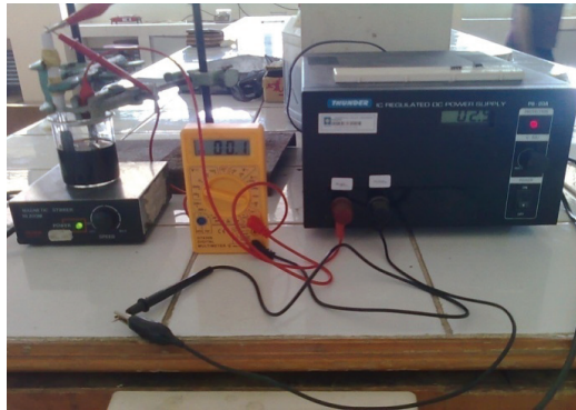
Gambar 4.5 Rangkaian alat elektrolisis untuk mendegradasi limbah batik
